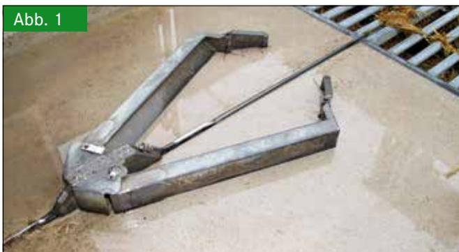
Neu entwickelter Faltkombischieber mit zusammenklappbaren Seitenflügeln
