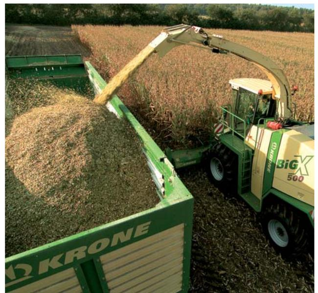
Selbstfahrender Feldhäckslers während des Häckselvorgangs im Parallelverfahren
