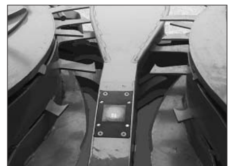
Bild 2: Messprinzip zur Bestimmung des Reifegrades von Mais (links) und Integration des Sensorsystems im Maisvorsatz des BiG X Feldhäckslers (rechts)
